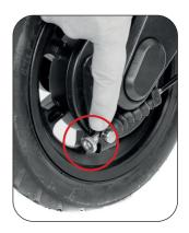
1. Nachdem Sie den Lenker montiert haben, drehen Sie als erstes die Einstellschraube der Vorderbremse gegen den Uhrzeigersinn auf, bis diese plan mit dem Gewinde abschließt.
